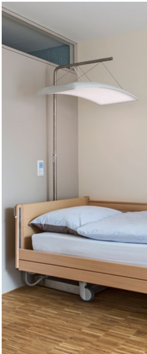
Prototyp der Dämmerungssimulationsleuchte für die Stiftung Hofmatt, Münchenstein. Wichtig für die therapeutische Wirkung ist der ausladende Schirm. So wird sichergestellt, dass ausreichend Licht zu den Nutzern gelangt. Mit einer separaten Handsteuerung können die gewünschten Aufwach- und Zubettgehzeiten auf die Leuchte übertragen werden. Tagsüber kann die Leuchte als Leselicht dienen.
